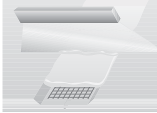
Zatmelení tmelem Rigidur
