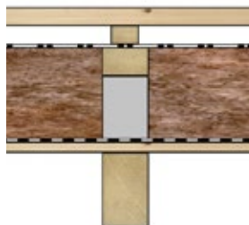
s použitím krokrového námětku ze dřeva a XPS
