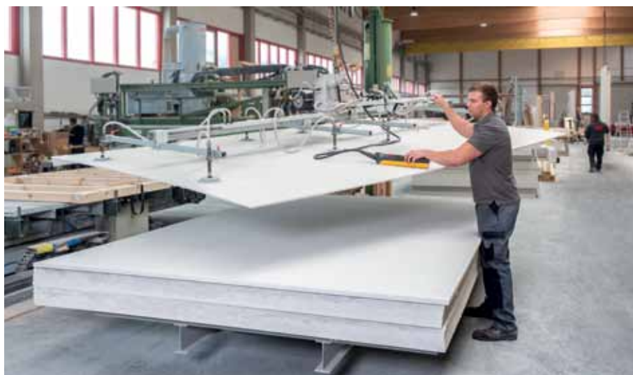
Manipulace se sádrovláknitými deskami fermacell pomocí vakuového zvedacího zařízení.
