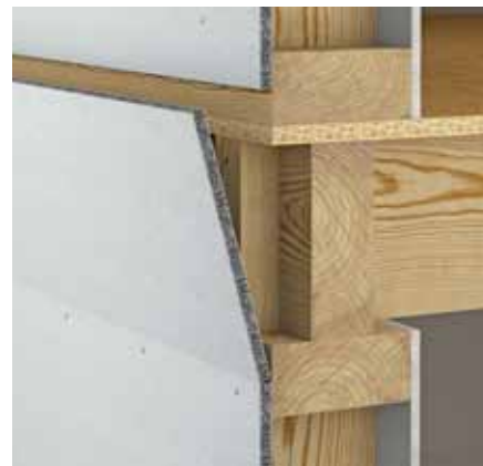
Obr. 2: montáž pruhů desek
